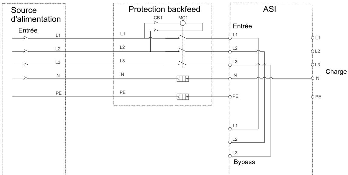
**ASI avec alimentations réseaux séparés et dispositif d'isolation externe**
