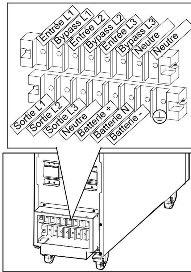
6. Raccordez les câbles d'entrée, de sortie et de bypass (le cas échéant).
