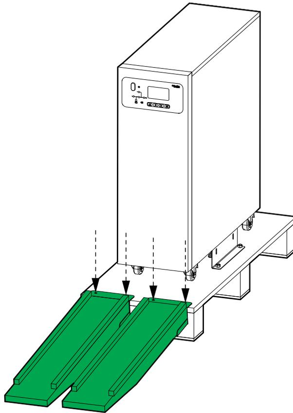
4. Desserrez les vis et retirez les supports d'expédition. Mettez ces derniers au rebut.
