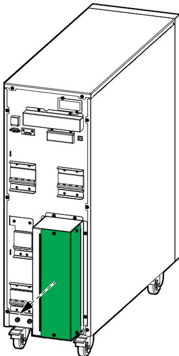
3. En cas d'alimentation par 2 sources, réseau principal et by-pass, retirer le câble pour alimentation mono source.
