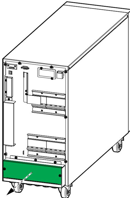
3. En cas d'alimentation par 2 sources, réseau principal et by-pass, retirer le câble pour alimentation mono source.
