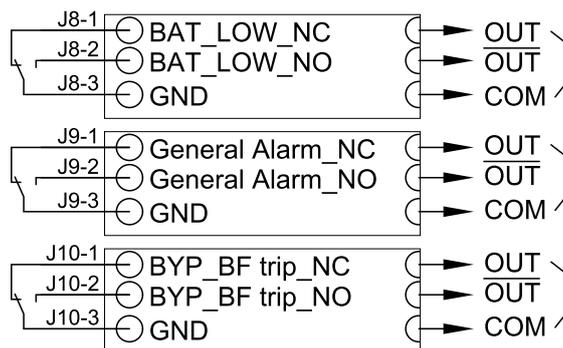
**Raccordement des câbles de signal dans des systèmes parallèles**
