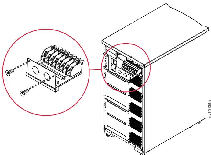
Insira o condúite de tamanho adequado através dos orifícios de alívio de tensão na bandeja de AC.
