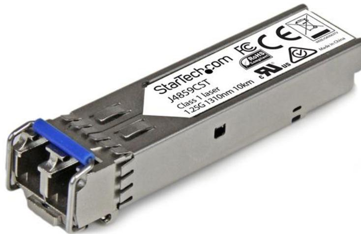
Le modèle J4859CST est un module de transceiver à fibre optique compatible avec HP J4859C, qui a été conçu, programmé et testé pour fonctionner avec les commutateurs et routeurs de la marque HP®. Il fournit une connectivité 1 GbE fiable sur câble à fibre optique pour les réseaux conformes aux spécifications 1000BASE-LX, avec une distance maximale de 10 km.
