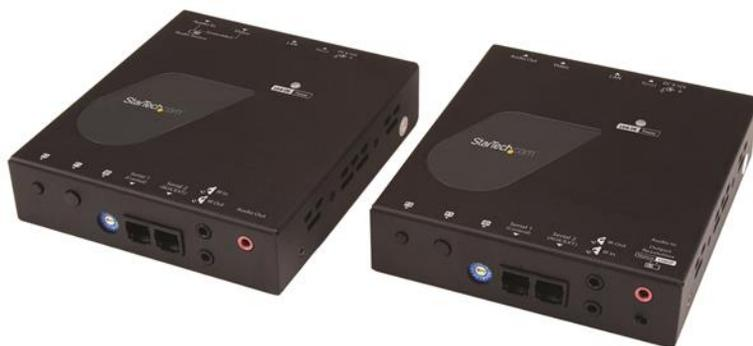
Grâce à cet extendeur HDMI® sur IP, placez librement des affichages numériques où vous le voulez. Étendez un signal HDMI 4K à l'aide de votre réseau local et diffusez des vidéos de façon homogène sur plusieurs écrans depuis une multitude d'appareils sources, simplifiant ainsi le positionnement de vos écrans ou la création d'un mur vidéo.
