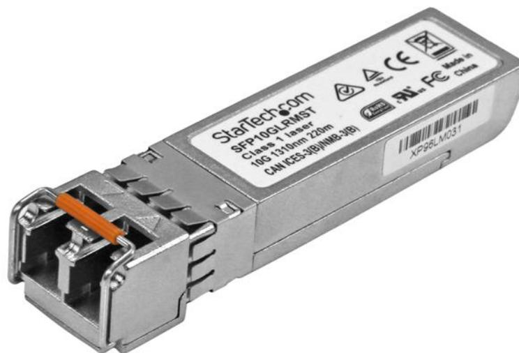
Le modèle SFP10GLRMST est un module de transceiver à fibre optique compatible avec Cisco SFP-10G-LRM, qui a été conçu, programmé et testé pour fonctionner avec les commutateurs et routeurs de la marque Cisco™. Il fournit une connectivité 10 GbE fiable sur câble à fibre optique pour les réseaux conformes aux spécifications 10GBASE-LRM, avec une distance maximale de 200 m.
