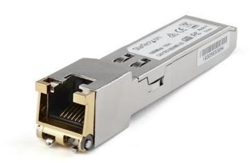
Le modèle GLCTEST est un module de transceiver en cuivre compatible avec Cisco GLC-TE, qui a été conçu, programmé et testé pour fonctionner avec les commutateurs et routeurs de la marque Cisco® sur une plage de températures étendue. Il fournit une connectivité 1 GbE fiable sur câble en cuivre pour les réseaux conformes aux spécifications 1000BASE-T, avec une distance maximale de 100 m.
