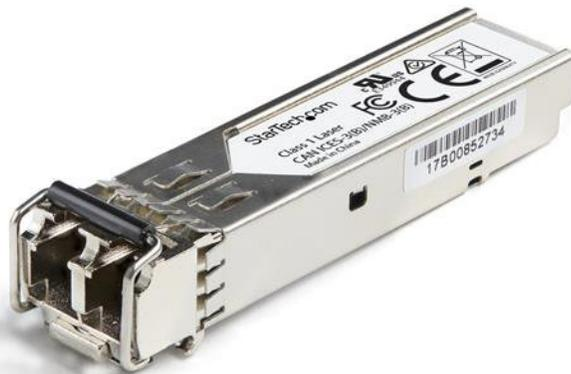
Le SFP1GSXEMCST est un module de transceiver SFP fibre compatible Dell EMC SFP-1G-SX qui a été conçu, programmé et testé pour fonctionner avec des commutateurs et des routeurs de marque Dell EMC™. Il vous assure une connectivité de 1 GbE par câble en fibre, sur les réseaux compatibles 1000Base-SX et sur une distance maximale de 550 m.
