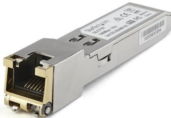
Le SFP1GTEMCST est un module de transceiver SFP cuivre compatible Dell EMC SFP-1G-T qui a été conçu, programmé et testé pour fonctionner avec des commutateurs et des routeurs de marque Dell EMC™. Il vous assure une connectivité de 1 GbE par câble en cuivre, sur les réseaux compatibles 1000Base-T et sur une distance maximale de 100 m.
